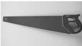
Fuchsschwanz (feinzahnig) zum Zuschneiden der Platte
