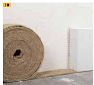
18 Elastische Entkopplung zum Fußboden
