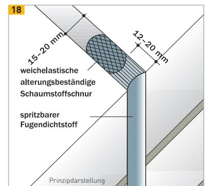
Dehnungsfuge mit spritzbarem Fugendichtstoff
