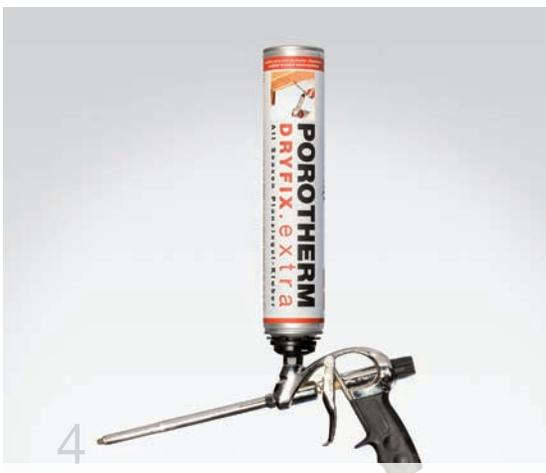
4 Die DRYFIX extra Dose vor jeder Inbetriebnahme ca. 20x schütteln und auf den Pistolen-Adapter schrauben. Die Stellschraube aufdrehen und den Abzughebel mind. 2 Sek. drücken, um den Pistolenlauf mit Kleber zu füllen. Der Kleberaustritt ist mit der Stellschraube regulierbar.
