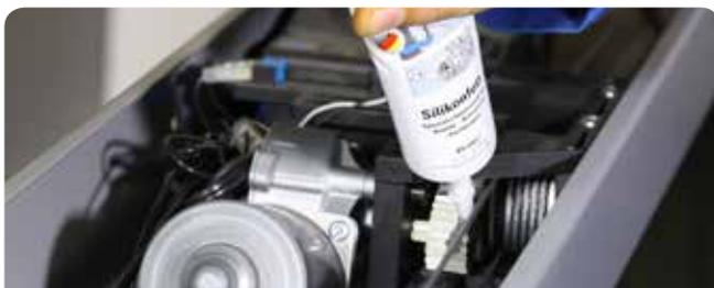
Fetten eines Kunststoffgetriebes
