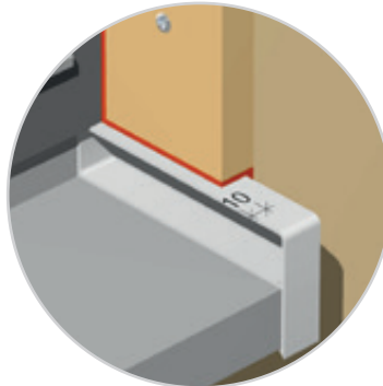
ca. 10 mm Versatz für Putzaufnahmen.
