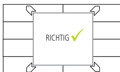
Keine Plattenstöße an Öffnungsecken!
