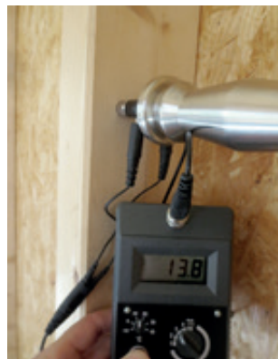
Holzfeuchte Holzständerkonstruktion \leq 18\% .
