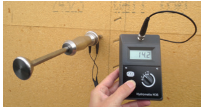
Plattenfeuchte ≤ 19,5 % mit Einstellung Fichte/Kiefer.
