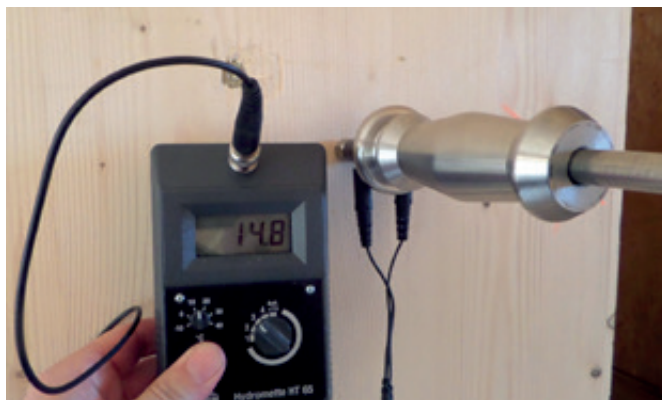
Holzfeuchte Holzständerkonstruktion \leq 18\% .
