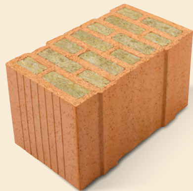
Porotherm 44 W.i Objekt Plan Wanddicke 44 cm U-Wert ab 0,16 W/m 2 K verputzt
