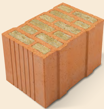
Porotherm 38 W.i Objekt Plan Wanddicke 38 cm U-Wert ab 0,19 W/m 2 K verputzt
